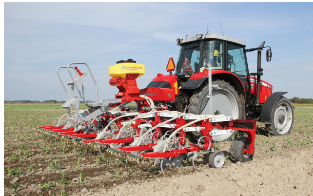
Ukrudtstrykket betyder, at vi må supplere radrensning med rækkedyrkning kombineret med radrensning. På billedet ses en kongskilde Vibro Crop Intelli rækkerenser monteret i en hydraulisk parallelforskydningsramme, som er koblet til traktoren. Foto: Udlånt af Kongskilde
